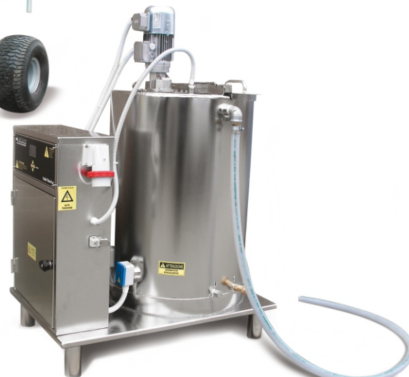
Стационарни пастьоризатори от 100 до 500 литра за приготвяне на пастьоризирано свежо мляко за телета, агнета или ярета. Съоразени са с награвате, специална бъркалка за свежо мляко, дистрибутор с дозираща помпа, както и двойна филтрационна система за водата.
