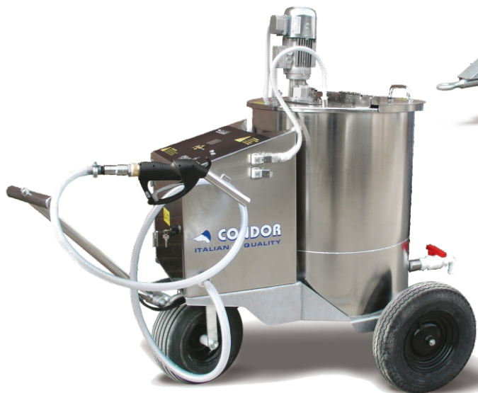
Млечни „таксита“ от 100 до 300 литра с или без пастьоризатор, с или без инверторно регулиране на оборотите, както и със или без дозираща система за раздаване на млякото. Съществува и опция за моторно задвижване на ходовата част.
