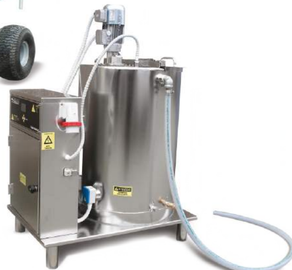
Стационарни пастьоризатори от 100 до 500 литра за приготвяне на пастьоризирано свежо мляко за телета, агнета или ярета. Съоразени са с нагрявател, специална бъркалка за свежо мляко, дистрибутор с дозираща помпа, както и двойна филтрационна система за водата.
